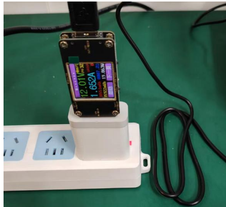
无线充 TX 检测到负载时，通过 DP/DM 申请 12V 输入电压
