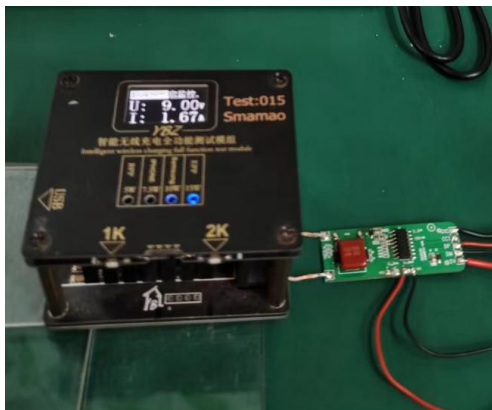
无线充 TX 检测到负载时，通过 DP/DM 申请 12V 输入电压
