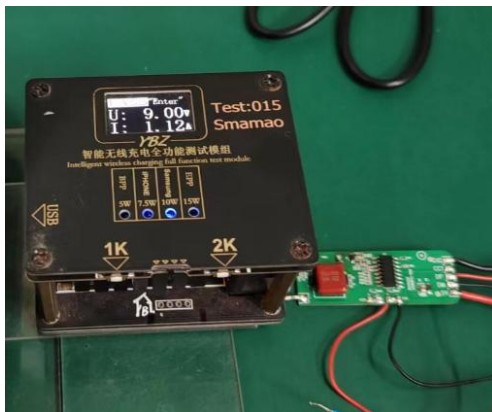
无线充 TX 检测到负载时，通过 DP/DM 申请 9V 输入电压
