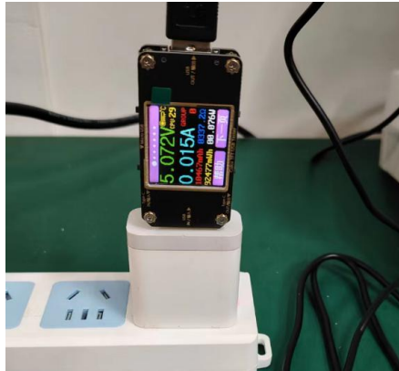
无线充 TX 待机空载时，输入电压 5V
